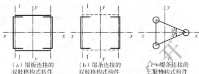
图 5.2.6 格构式构件截面示意图
