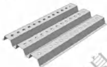
图 8.1.10 压型钢板翼缘开圆孔示意图
